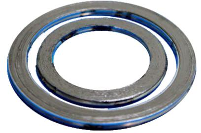
La junta tipo R no cuenta con ningún anillo guía, ya que normalmente se colocan en un alojamiento ranurado. Las dimensiones de las juntas R están directamente relacionadas a las dimensiones estándar de las ranuras. Un claro adecuado se proporciona en cada diseño de junta para evitar que se traslape en las ranuras de colocación. Los empaques tipo R tienen un espesor nominal de 0.125" para facilitar la alineación en la colocación de la junta.
