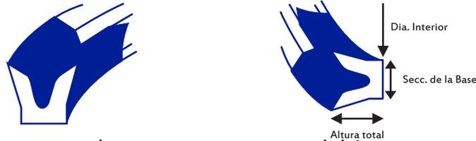
Los V'rings se dimensionan con tres mediciones, primeramente el diámetro interior del V'ring, después por la sección de la base, y por último la altura total del empaque.
