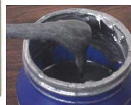
El compuesto anti – adherente REBCO a base de níquel, sella y protege las piezas en contacto que estan sujetas a condiciones extremas de calor, presión y corrosión.
