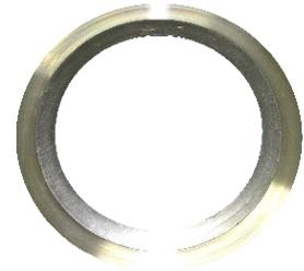
Para aplicaciones con alto estrés de asentamiento, se recomiendan empaques metálicos, sin embargo estos presentan la dificultad de no poder rellenar las imperfecciones de las bridas. Debido a esta dificultad, se diseñaron las juntas kamprofile, las cuales son empaques de acero sólido que tienen un rallado concéntrico y son recubiertas de grafito, el cual rellena las imperfecciones de la brida.
